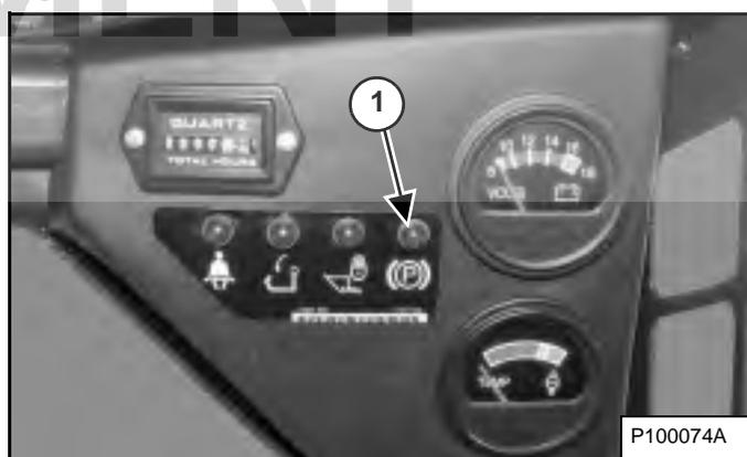
**REMARQUE :** le témoin du **FREIN DE STATIONNEMENT** (1) [Figure 18] du tableau de bord droit reste **ALLUMÉ** jusqu'à ce que le moteur soit démarré, que le bouton **PRESS TO OPERATE LOADER** (**APPUYER POUR UTILISER LA CHARGEUSE**) soit enfoncé et que le frein de stationnement soit relâché.
