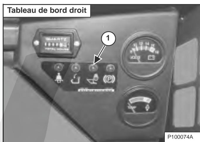
Enfoncez le bouton PRESS TO OPERATE LOADER (APPUYER POUR UTILISER LA CHARGEUSE) (1) [Figure 48] pour activer le système BICST™ et les fonctions hydrauliques de la chargeuse. Le témoin de levage et de cavage (1) [Figure 49] s'ÉTEINT lorsque le système BICST™ est actif.
