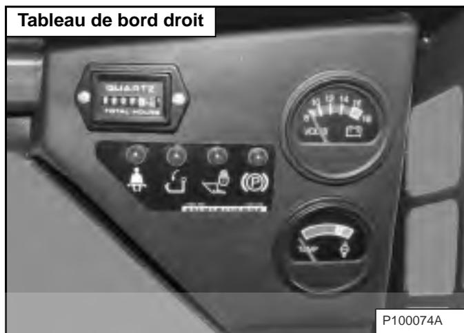
Contrôlez régulièrement la jauge de température et les témoins BICS™ [Figure 55]. Tous les témoins BICS™ doivent être éteints pour utiliser la chargeuse (voir DISPOSITIF DE VERROUILLAGE BOBCAT (BICS™), page 77).
