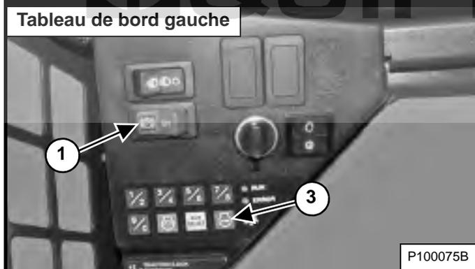
Tournez le contacteur à clé sur la position ARRÊT (2) ou appuyez sur le bouton STOP (3) [Figure 57].
