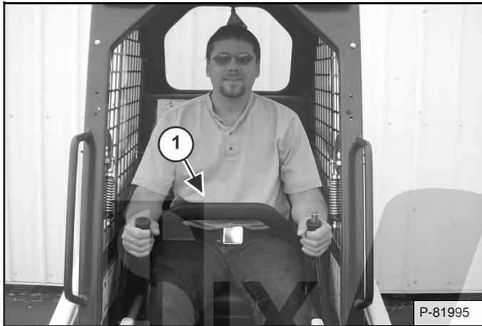
Le dispositif de verrouillage Bobcat (BICS™) comprend un arceau de siège pivotant avec accoudoirs (1) [Figure 14]. L'utilisation de l'arceau de siège est commandée par l'opérateur.
