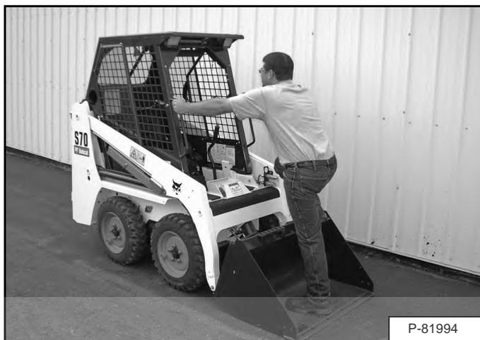
Utilisez les marchepieds du godet ou de l'accessoire, les mains courantes et l'antidérapant (sur les bras de levage et le châssis de la chargeuse) pour monter et descendre de la chargeuse en maintenant en permanence un contact en 3 points [Figure 40]. NE SAUTEZ PAS.
