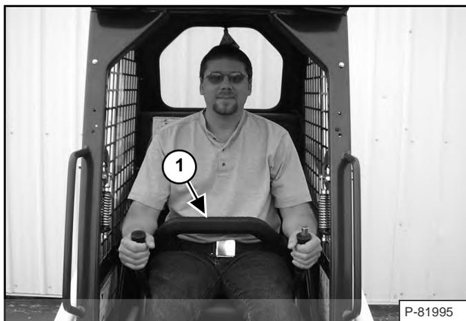
Le dispositif de sécurité de l'arceau de siège comprend un arceau de siège pivotant avec accoudoirs (1) [Figure 13].
