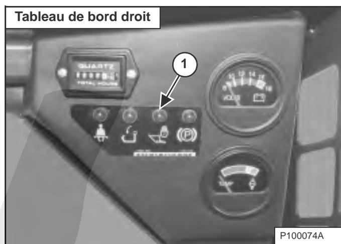
Enfoncez le bouton PRESS TO OPERATE LOADER (APPUYER POUR UTILISER LA CHARGEUSE) (1) [Figure 53] pour activer le système BICST™ et les fonctions hydrauliques de la chargeuse. Le témoin de levage et de cavage (1) [Figure 54] s'ÉTEINT lorsque le système BICST™ est actif.
