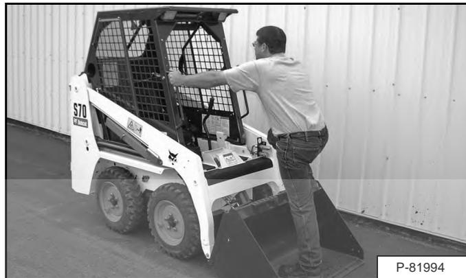
Sortez de la chargeuse en utilisant les mains courantes, les antidérapants et les marchepieds (en maintenant un contact en 3 points) [Figure 58].
