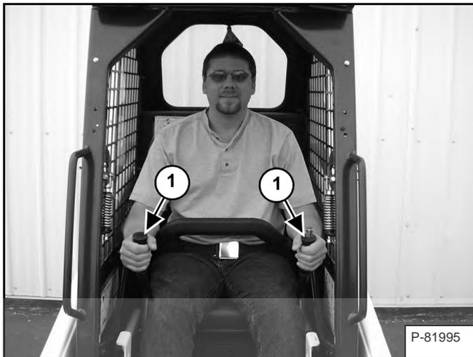
Les leviers de commande (1) [Figure 27] se trouvent à droite et à gauche à l'avant du siège.
