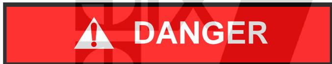
Le terme de mise en garde DANGER utilisé sur la machine et dans les manuels indique une situation dangereuse qui, si elle n'est pas évitée, va provoquer des blessures graves, voire mortelles.
