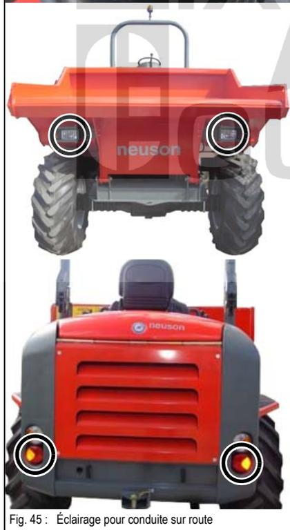
Fig. 45 : Éclairage pour conduite sur route
