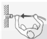
Toujours se placer absolument à côté du câble de poussée !
