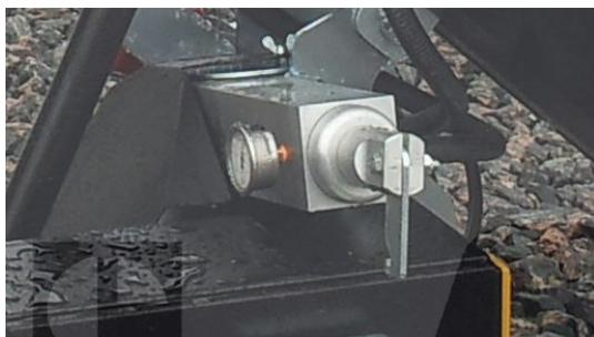
Figure 12 : boîte 3" avec filtre à eau (500 microns)
