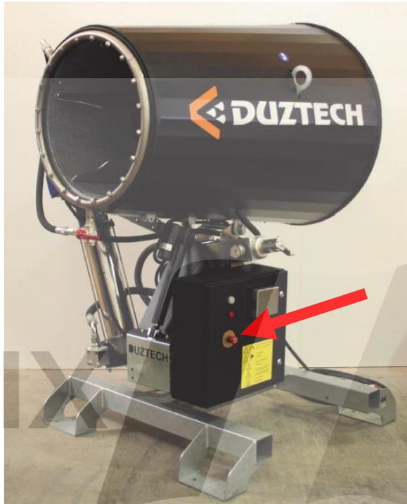
Figure 36 : bouton d'arrêt d'urgence, emplacement
