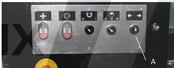
Figure 50 : interrupteur pour la rotation manuelle
