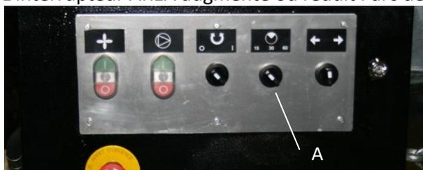
Figure 49 : interrupteur servant à modifier l'arc de rotation
