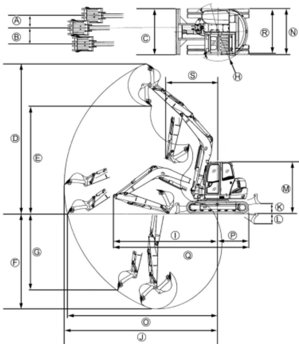
Toutes les dimensions sont indiquées en mm pour une machine équipée du godet d'origine KUBOTA et de chenilles en caoutchouc
