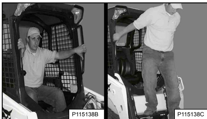
Sortez de la chargeuse en utilisant les mains courantes, les antidérapants et les marche-pieds (en maintenant un contact en trois points) [Figure 129].
