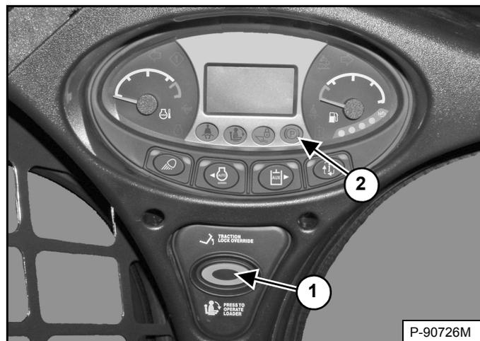
(Fonctionne uniquement lorsque l'arceau de siège est relevé et que le moteur tourne) La commande de déverrouillage de la transmission (TRACTION LOCK OVERRIDE) (1) [Figure 35] se trouve sur le tableau de bord gauche. Elle permet de déplacer la chargeuse en marche avant ou arrière à l'aide des commandes de direction en cas d'utilisation de la pelle rétro.
