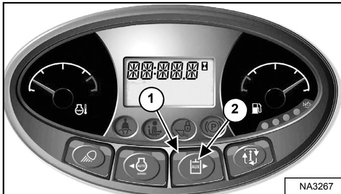
Appuyez une fois sur le bouton du circuit hydraulique auxiliaire (2) [Figure 86] pour l'activer.
