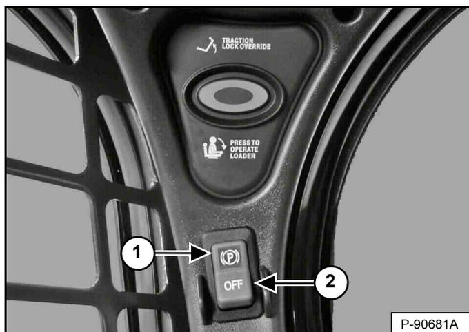
Enclenchez le frein de stationnement en appuyant sur le haut du contacteur (1) [Figure 34]. Le témoin rouge du contacteur s'ALLUME. La transmission est verrouillée.
