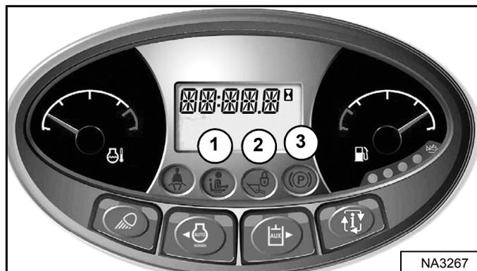
Les trois témoins (1, 2 et 3) [Figure 32] du tableau de bord gauche doivent être ÉTEINTS pour pouvoir utiliser la machine avec toutes ses fonctions.
