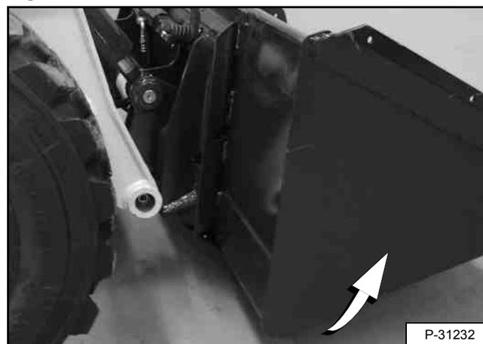
Inclinez le Bob-Tach vers l'arrière jusqu'à ce que le bord d'attaque du godet (ou autre accessoire) décolle légèrement du sol [Figure 141]. Cette procédure permet au châssis de fixation du godet de se plaquer contre l'avant du Bob-Tach.
