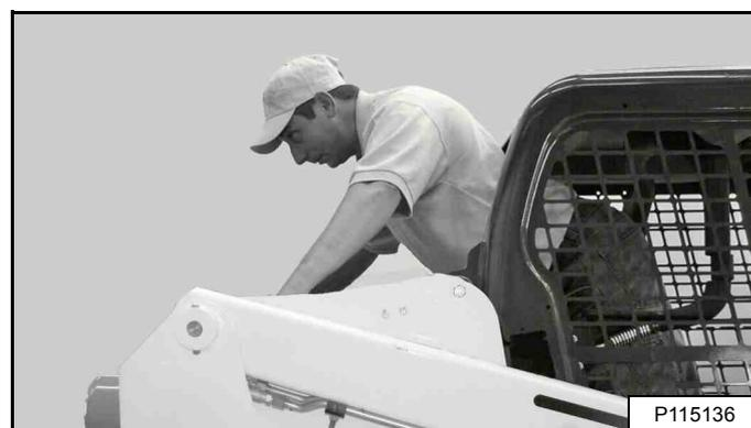
Sortez de la chargeuse par l'arrière de la cabine [Figure 43].
