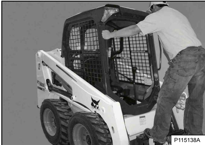
Utilisez les marchepieds du godet ou de l'accessoire, les mains courantes et l'antidérapant (sur les bras de levage et le châssis de la chargeuse) pour monter et descendre de la chargeuse en maintenant en permanence un contact en trois points [Figure 99]. Ne sautez pas.
