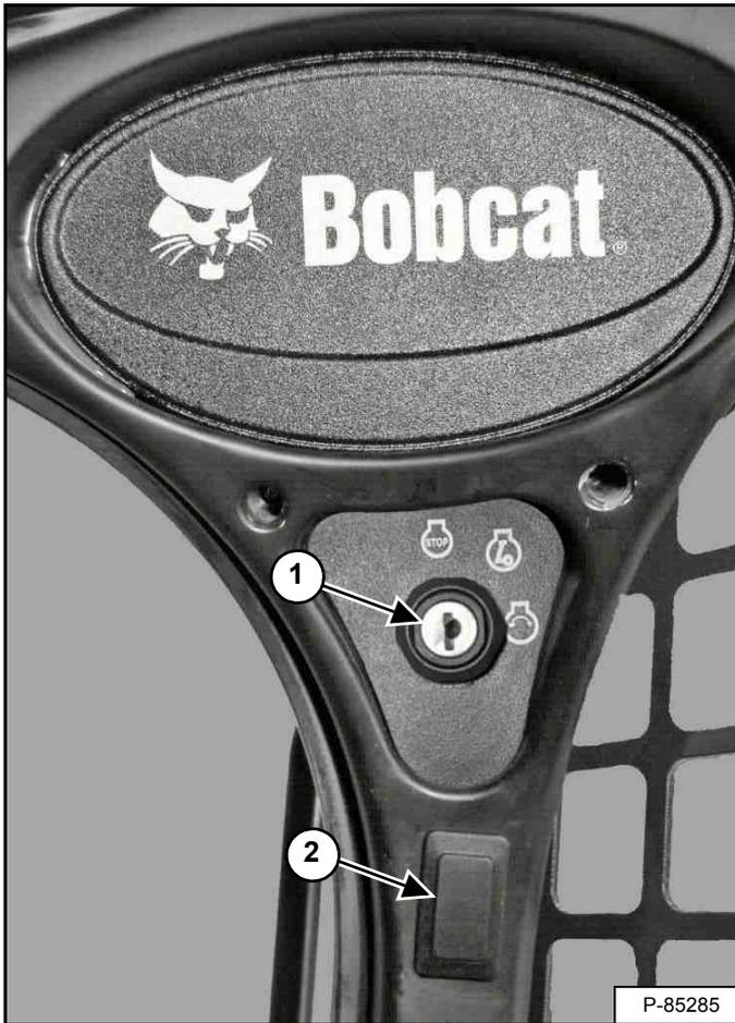
Cette machine peut être équipée d'un tableau standard à contacteur à clé [Figure 13].
