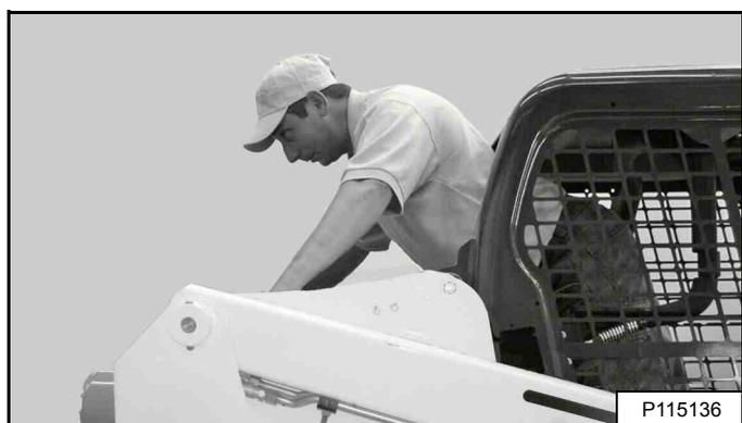
Sortez de la chargeuse par l'arrière de la cabine [Figure 41].
