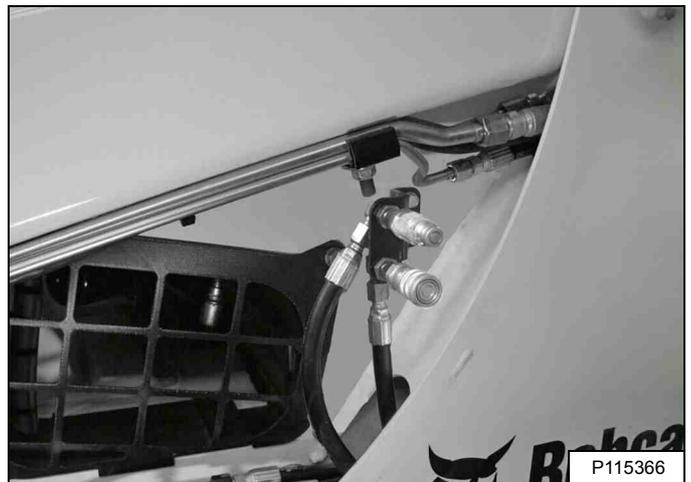
Déplacez le contacteur du circuit hydraulique auxiliaire arrière (1) [Figure 87] ou [Figure 88] vers la droite ou vers la gauche pour inverser le débit d'huile hydraulique des raccords rapides arrière [Figure 89]. (côté gauche en illustration). (EXEMPLE : montée et descente des stabilisateurs arrière). Relâchez le contacteur pour arrêter le débit d'huile.
