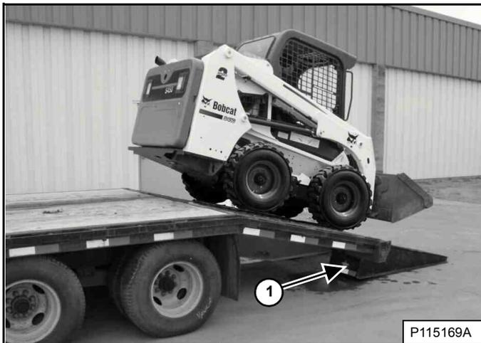
Faites monter la chargeuse en marche arrière sur le véhicule de transport si le godet est vide, ou si l'accessoire a été déposé [Figure 175].
