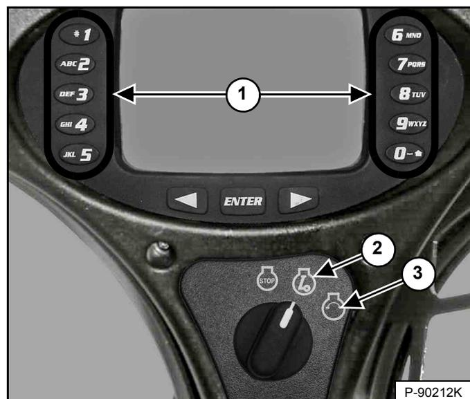
Tournez le contacteur à clé sur la position RUN (Marche) (2) [Figure 122]. Les témoins du tableau de bord gauche s'ALLUMENT brièvement tandis que le tableau de bord/système de surveillance exécute un test automatique.
