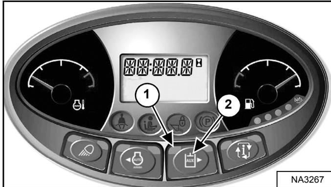
Appuyez une fois sur le bouton du circuit hydraulique auxiliaire (2) [Figure 81] pour l'activer.
