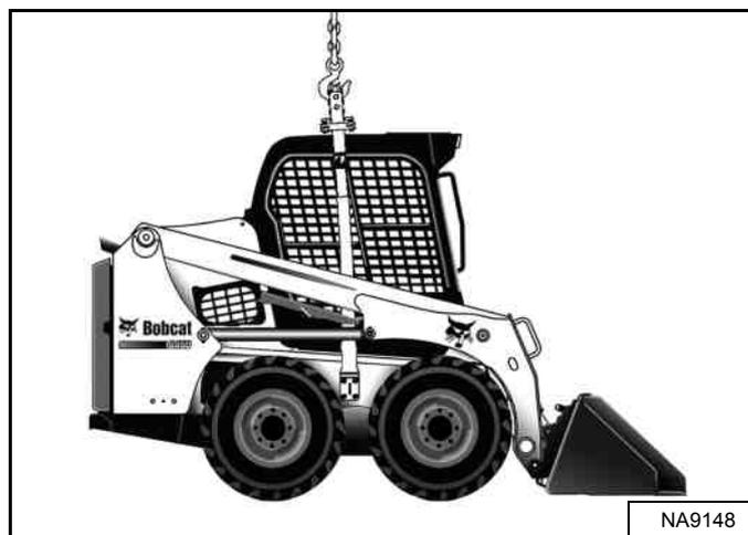
Fixez le crochet de levage au point de levage [Figure 172].
