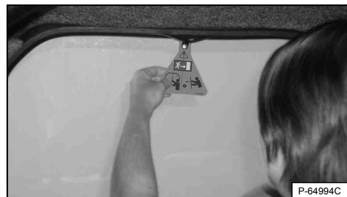
Tirez sur l'étiquette en haut de la vitre arrière pour retirer le cordon en caoutchouc [Figure 42].
