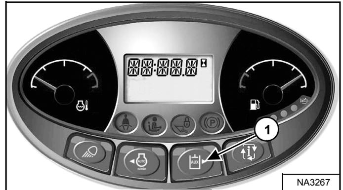
Appuyez sur le bouton du circuit hydraulique auxiliaire (1) [Figure 91].
