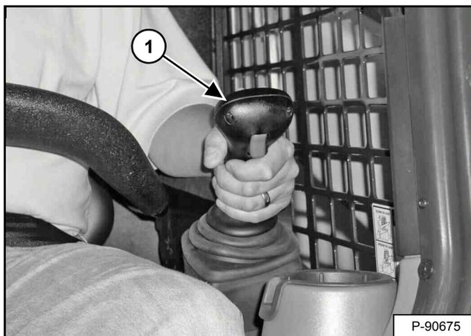
Le manipulateur qui commande la translation et la direction se trouve à gauche à l'avant du siège (1) [Figure 56].
