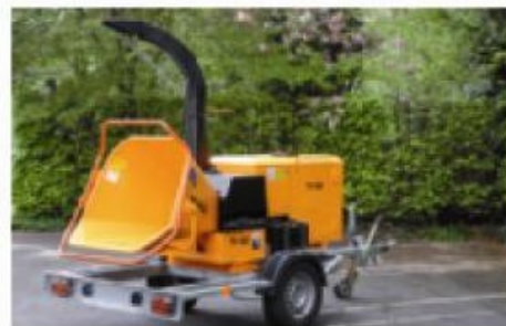
Entraînement par moteur sur châssis pour transport rapide
