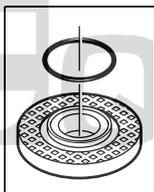
Un joint en plastique (rondelle élastique) est directement monté autour de l'alésage du flasque **8**. **Au cas où cette rondelle élastique fasse défaut ou qu'elle soit endommagée, il faut absolument remplacer la flasque d'entraînement **8** avant de continuer à l'utiliser l'outil.**
