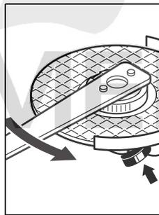
Un écrou de serrage rapide non endommagé qui a été correctement fixé peut être desserré à la main en tournant l'anneau moleté dans le sens inverse des aiguilles d'une montre.
