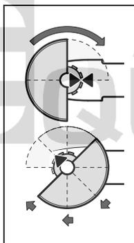
Montez le capot de protection **12** sur la tête de broche conformément à la figure. Les marques triangulaires se trouvant sur le capot de protection doivent coïncider avec les marquages correspondants sur la tête d'engrenage.
