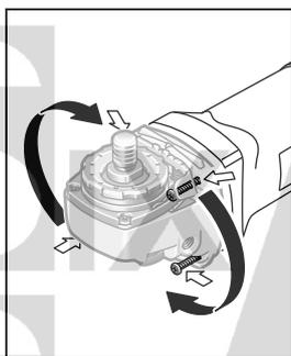
Il est possible de faire pivoter le carter d'engrenage par paliers de 90°. Ceci permet de mettre l'interrupteur Marche/Arrêt dans une position de maniement favorable à des utilisations spécifiques, p. ex. pour des travaux de tronçonnage effectués au moyen du carter d'aspiration avec glissière de guidage **20** ou pour les gauchers.
