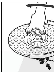
Un écrou de serrage rapide non endommagé qui a été correctement fixé peut être desserrée à la main en tournant l'anneau moleté dans le sens inverse des aiguilles d'une montre.
