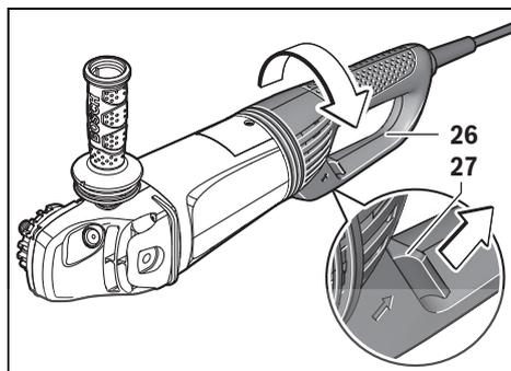
Il est possible de faire pivoter la poignée principale 26 de 90° vers la gauche ou vers la droite par rapport au carter moteur. Ceci permet de mettre l'interrupteur Marche/Arrêt dans une position de maniement favorable à des utilisations spécifiques, p. ex. pour des travaux de tronçonnage effectués au moyen du carter d'aspiration avec glissière de guidage 22 ou pour les gauchers.
