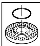
Un joint en plastique (rondelle élastique) est directement monté autour de l'alésage du flasque 10. **Au cas où cette rondelle élastique fasse défaut ou qu'elle soit endommagée**, il faut absolument remplacer la flasque d'entraînement 10 avant de continuer à l'utiliser l'outil.
