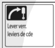
Si le verrouillage des leviers de commande n'est pas relevé, le message montré sur l'illustration de droite est affiché.
