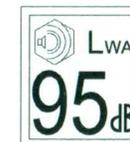
2.1. CE-marquage et autocollant relatif au bruit: voici un exemple d'autocollant d'identification EUROPOWER et d'un autocollant relatif au bruit. L'autocollant d'identification se trouve sur chaque groupe électrogène. L'autocollant relatif au bruit se trouve seulement sur les groupes électrogènes qui répondent à la Directive européenne 2000/14/CE. Pour plus d'information consultez la documentation EUROPOWER ou le site web: [www.europowergenerators.com](http://www.europowergenerators.com).
