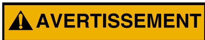
Le terme de mise en garde AVERTISSEMENT utilisé sur la machine et dans les manuels indique une situation dangereuse qui, si elle n'est pas évitée, peut provoquer des blessures graves, voire mortelles.
