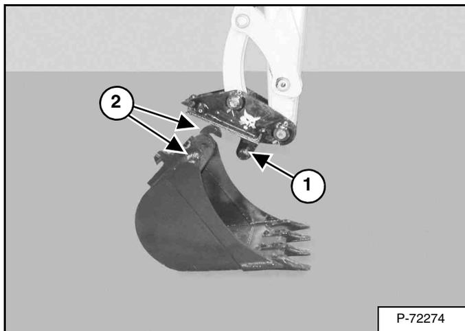
Assurez-vous que l'attache rapide n'est pas usée ou endommagée. Assurez-vous que les broches de l'attache rapide (1) et les crochets (2) de l'accessoire [Figure 112] ne sont pas usés ou endommagés.
