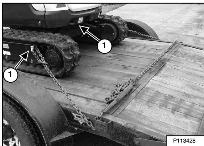
Fixez des chaînes aux coins avant de la lame (1) [Figure 147] (ou au coin avant de la tourelle) et aux points d'arrimage des bâtis des deux côtés du bâti de chenille (1) [Figure 148] (ou au point d'arrimage à l'arrière de la tourelle) pour empêcher la machine de bouger lorsque le véhicule de transport monte ou descend une pente ou en cas d'arrêt brutal.
