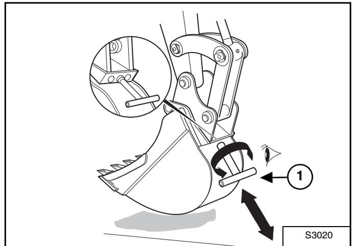
Insérez la clé à douille (1) [Figure 96] dans la plaque de verrouillage, puis tournez dans le sens antihoraire jusqu'au déverrouillage.
