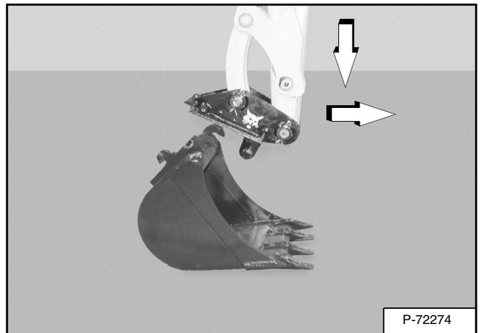
Continuez d'abaisser la flèche en déplaçant le balancier vers la pelle compacte jusqu'à ce que l'attache rapide soit dégagée de l'accessoire [Figure 111].
