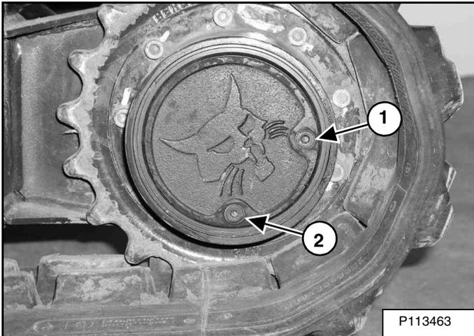
Garez la pelle compacte sur une surface plane et de niveau avec les bouchons (1 et 2) [Figure 206] dans la position indiquée.
