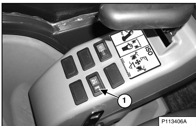
Déplacez le contacteur de commande de la lame / d'écartement et de rapprochement des chenilles (1) [Figure 54] en position Rapprochement et écartement des chenilles.
