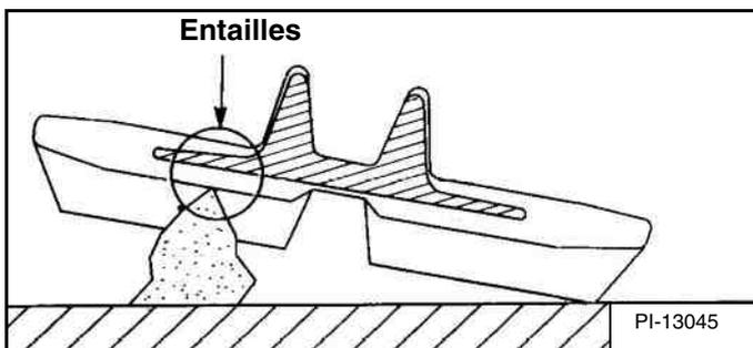
Lorsque les chenilles en caoutchouc passent sur des pointes ou des arêtes tranchantes, les forces concentrées appliquées peuvent entailler l'enveloppe en caoutchouc [Figure 141]. En cas de virage sur une pointe ou une arête, le risque d'entailles est encore accru. Si les entailles parviennent jusqu'aux câbles en acier intégrés, elles peuvent entraîner leur rupture par corrosion.
