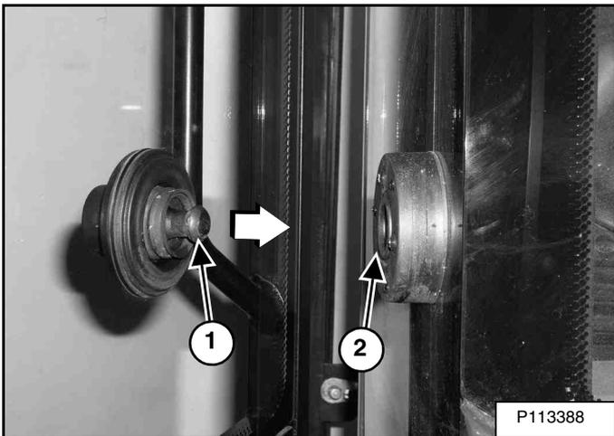
Pour verrouiller la porte en position ouverte, ouvrez-la complètement en la poussant jusqu'à ce que la butée (1) s'engage dans le verrou (2) [Figure 16].
