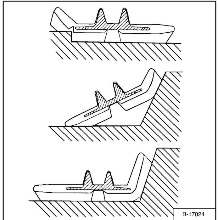
Lorsque les chenilles en caoutchouc passent sur des arêtes ou des rebords, une contrainte extrême est exercée sur l'enveloppe en caoutchouc, en particulier au niveau des bords des inserts métalliques, entraînant des fissures et des entailles dans cette zone [Figure 142].
