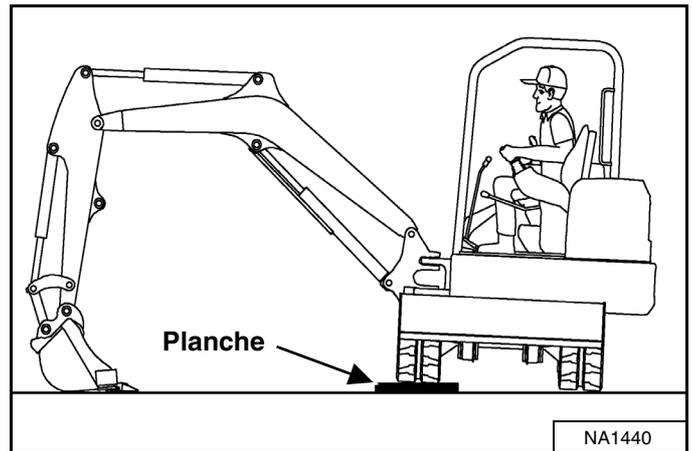
Si une ou les deux chenilles s'embourbent dans un sol meuble ou humide, relevez une chenille à la fois en faisant pivoter la tourelle et en exerçant une pression contre le sol avec le godet [Figure 132].
