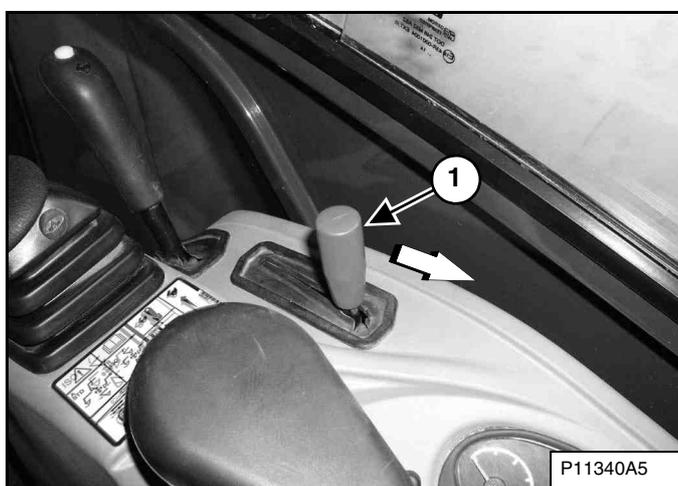
Tirez le levier d'accélérateur (1) [Figure 82] vers l'arrière en position de ralenti.
