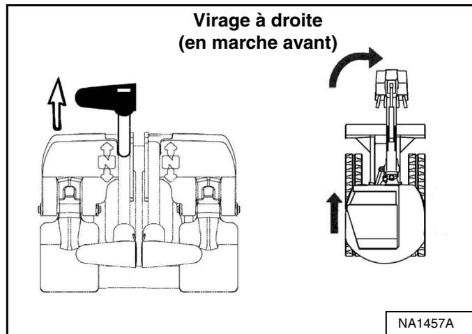
Poussez le levier de direction gauche vers l'avant pour tourner à droite [Figure 33] en marche avant.
