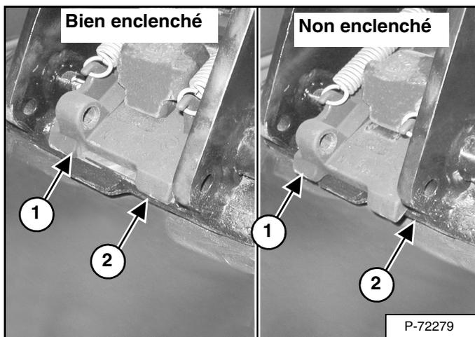
Contrôlez visuellement l'enclenchement du verrou de l'attache rapide (1) dans le châssis de fixation du godet (2) [Figure 107]. Le verrou doit être enclenché à fond.
