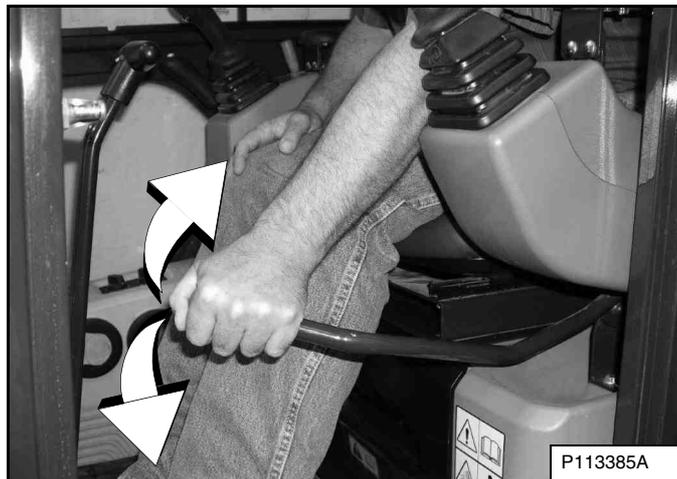
Le contacteur de verrouillage des manipulateurs désactive les fonctions de travail et de translation lorsque la console est relevée [Figure 113].
