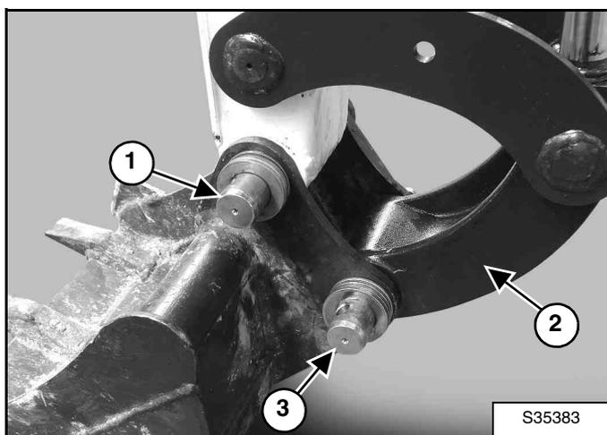
Positionnez le balancier sur le godet et alignez les trous de montage.
