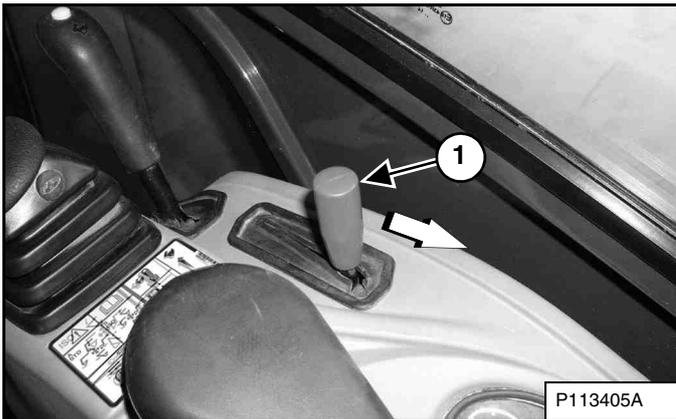
Tirez le levier d'accélérateur (1) [Figure 87] vers l'arrière en position de ralenti.
