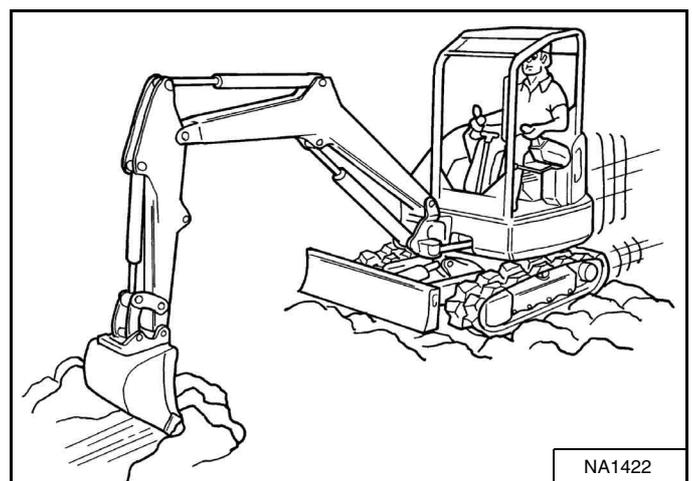
Le godet peut également être utilisé pour tirer la pelle compacte. Levez la lame, étendez le balancier et abaissez la flèche. Utilisez la flèche et le balancier comme pour une excavation [Figure 133].
