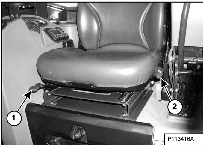
Libérez le levier du siège (1) [Figure 74] pour avancer ou reculer le siège.
