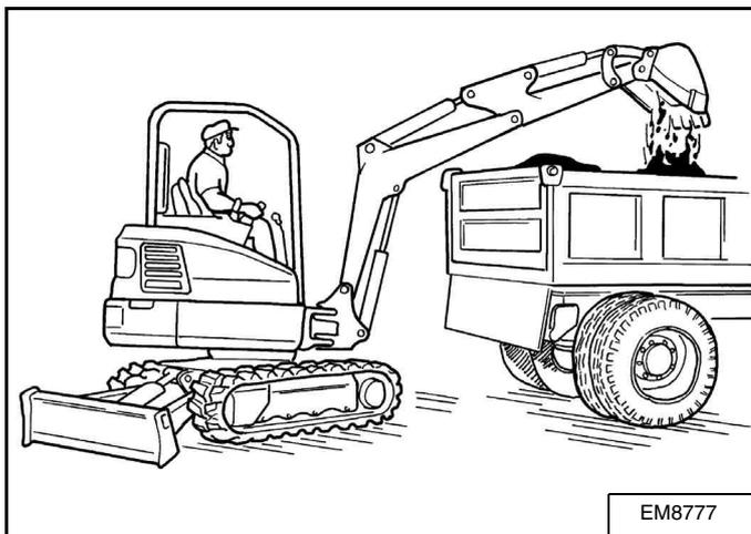
Étendez le balancier et ouvrez le godet pour déverser la charge dans une benne ou sur un tas [Figure 125].
