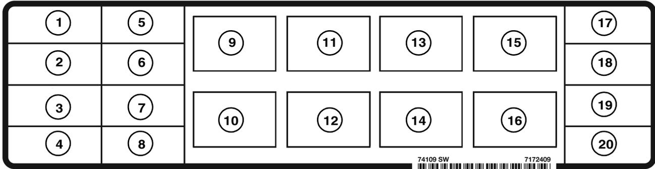
L'emplacement et l'ampérage des fusibles sont indiqués dans le tableau ci-dessous et sur l'autocollant [Figure 183]. Les relais sont identifiés dans la colonne AMP par la lettre « R ».
