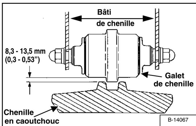
Mesurez l'écartement à l'un des galets du milieu. N'approchez pas les doigts du point de pincement entre la chenille et le galet. À l'aide d'un boulon ou d'un axe de taille adéquate, contrôlez l'écartement entre le bord de contact du galet et le bord supérieur du crampon de guidage de la chenille [Figure 203] et [Figure 204].
