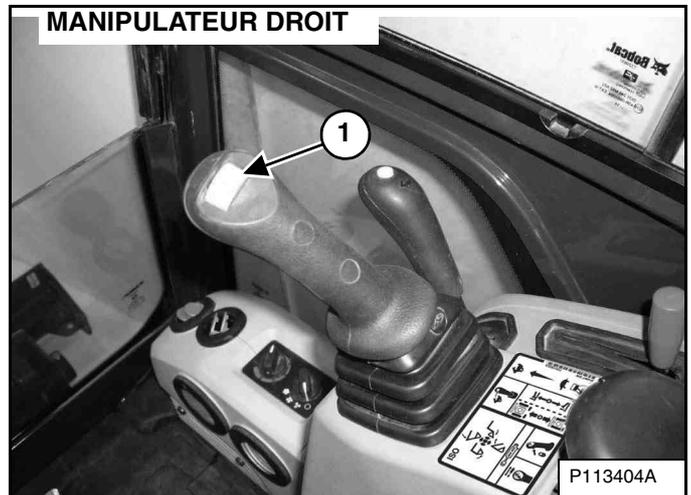
Si la machine est équipée du contacteur sur le manipulateur droit, déplacez le contacteur (1) [Figure 119] vers la droite pour ouvrir la pince. Déplacez le contacteur vers la gauche pour fermer la pince.
