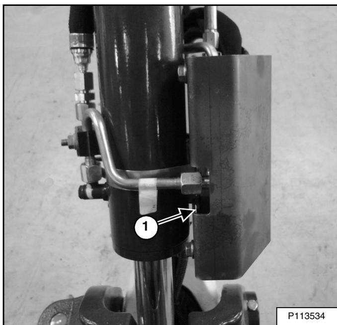
Si la pelle compacte est équipée d'un clapet de maintien de charge de la flèche (1) [Figure 60], celui-ci est monté sur le vérin de flèche, côté tige.
