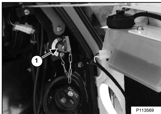
Le coupe-batterie (1) [Figure 184] se situe sous le capot latéral droit, au-dessus du bouchon du réservoir de carburant.
