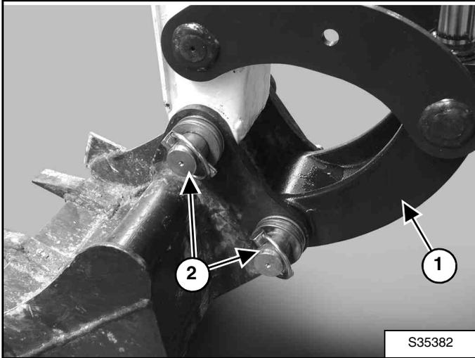
Vérifiez que l'articulation du godet (1) n'est pas usée ou endommagée. Vérifiez que les broches de l'accessoire (2) [Figure 209] ne sont pas usées ou endommagées.
