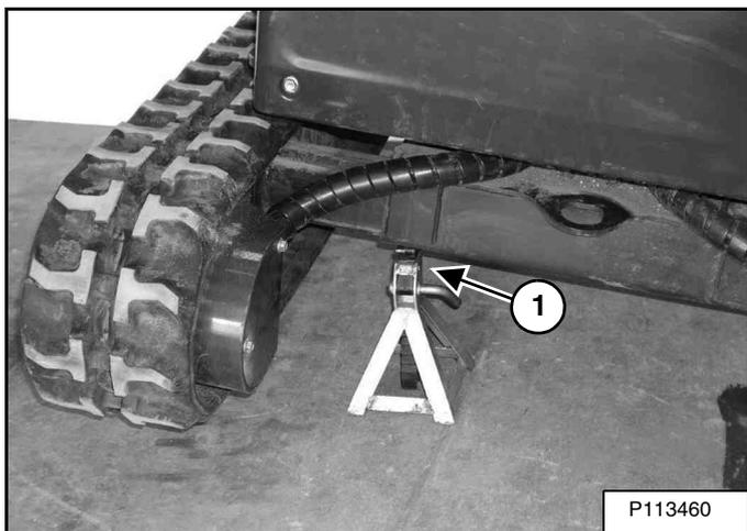
Levez complètement la lame et placez des chandelles sous la lame et le châssis inférieur (1) [Figure 201] et [Figure 202]. Levez la flèche jusqu'à ce que tout le poids de la machine soit soutenu par les chandelles.
