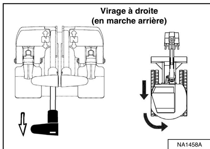
Tirez le levier de direction gauche vers l'arrière pour tourner à droite en marche arrière [Figure 34].
