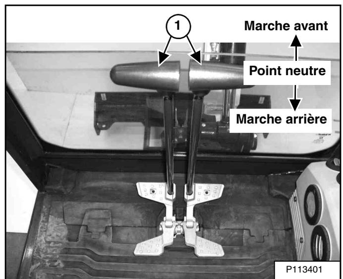
Pour freiner la machine en descendant une pente, ramenez les leviers de direction (1) [Figure 138] au *POINT NEUTRE*. Cela permet d'activer le frein hydrostatique.
