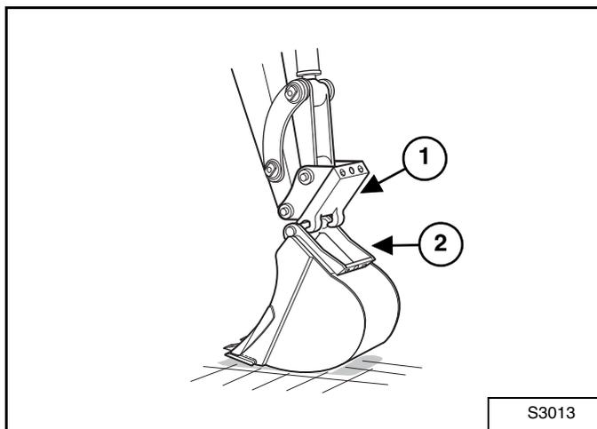
Abaissez l'attache rapide Bobcat (1) sur l'adaptateur (2) [Figure 91] du godet.
