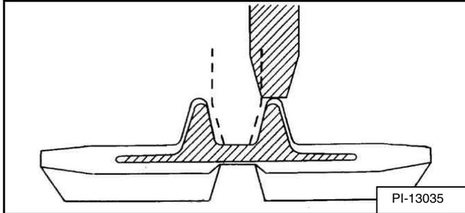
Tension des chenilles incorrecte : lorsque les chenilles en caoutchouc ne sont pas suffisamment tendues, la roue de tension ou le barbotin passe sur les crampons de guidage et dénude les inserts métalliques [Figure 140], ce qui entraîne la corrosion de ces derniers (reportez-vous à TENSION DES CHENILLES, page 134).
