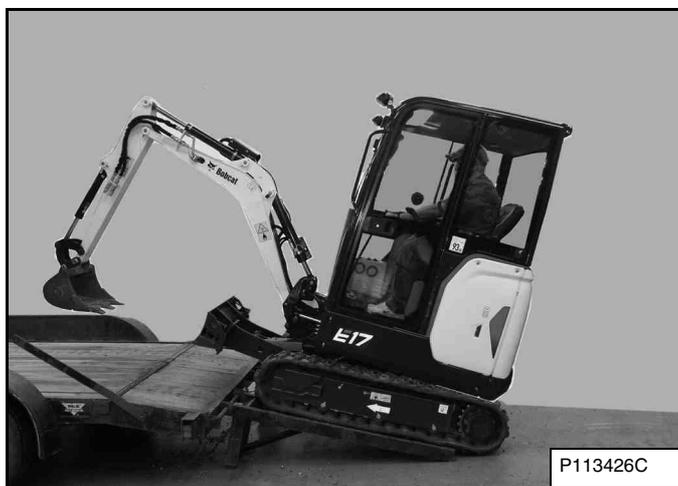
Faites monter la machine en marche avant sur la remorque [Figure 146].
