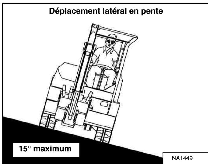
Lors de l'ascension d'une pente ou d'un déplacement latéral sur une pente de 15 degrés maximum, positionnez la machine comme illustré et faites tourner le moteur à bas régime [Figure 135] et [Figure 136].
