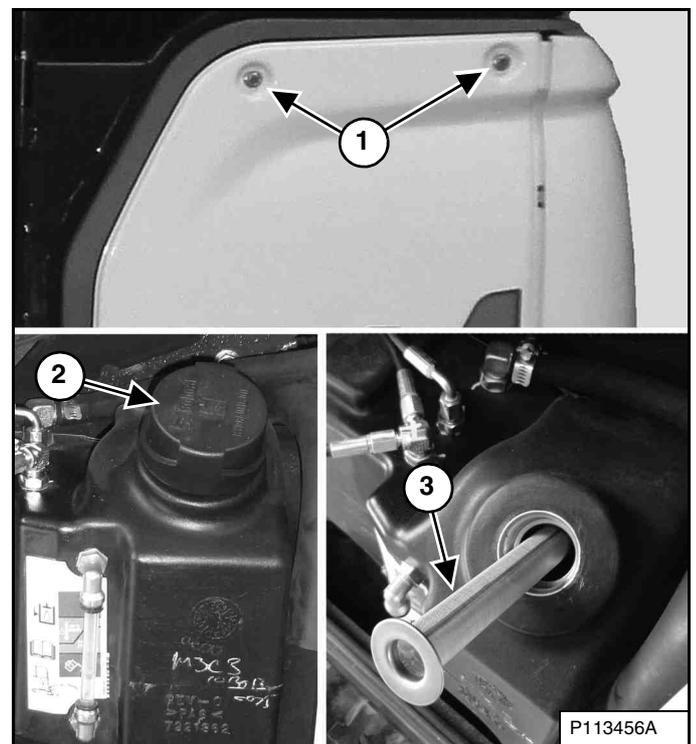
Retirez les deux vis (1) [Figure 194] au sommet du capot latéral gauche et retirez le capot.
