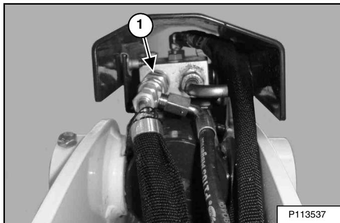
**REMARQUE : NE retirez PAS et N'ajustez PAS le clapet de sécurité secondaire (1) [Figure 65] (relié au flexible de vidange). Si le clapet de sécurité secondaire a été altéré, faites contrôler la machine par votre concessionnaire Bobcat.**
