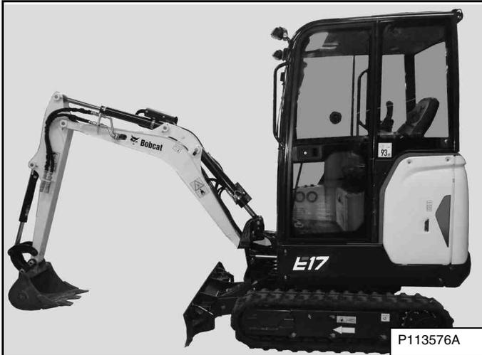
Écartez les chenilles au maximum. Garez la machine sur une surface plane et de niveau. Posez le groupe de travail et la lame au sol [Figure 86].
