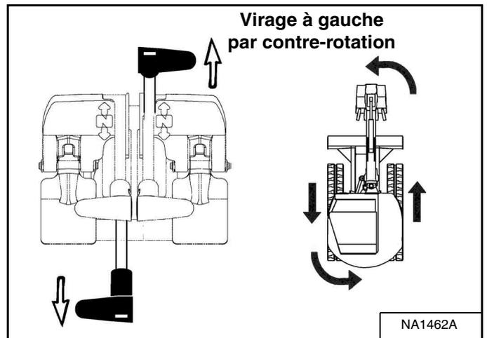
Poussez le levier de direction droit vers l'avant et tirez le levier de direction gauche vers l'arrière [Figure 38].
