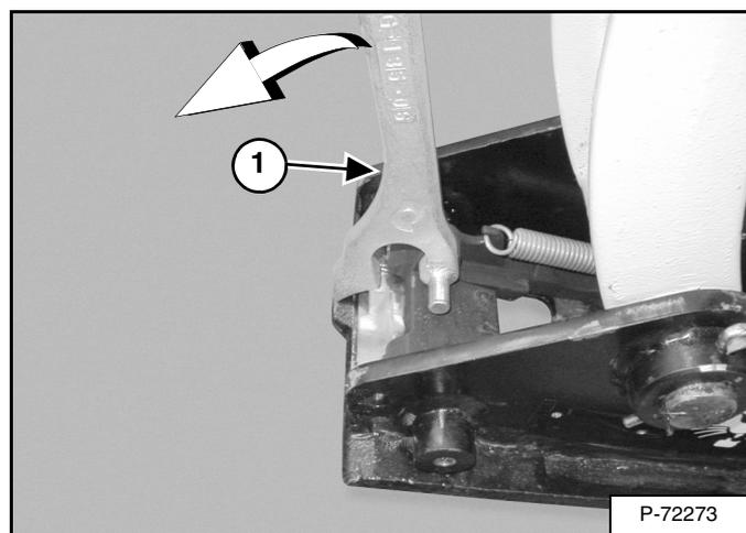
Pour déverrouiller l'attache rapide, engagez l'outil (1) [Figure 101] et tirez sur la poignée. Le verrou doit avancer entièrement. Le verrou se bloque en position déverrouillée.
