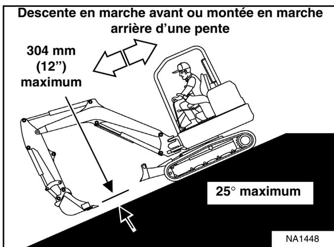
Pour descendre une pente dont l'inclinaison est supérieure à 15 degrés, placer la machine dans la position illustrée et se déplacer lentement [Figure 134].
