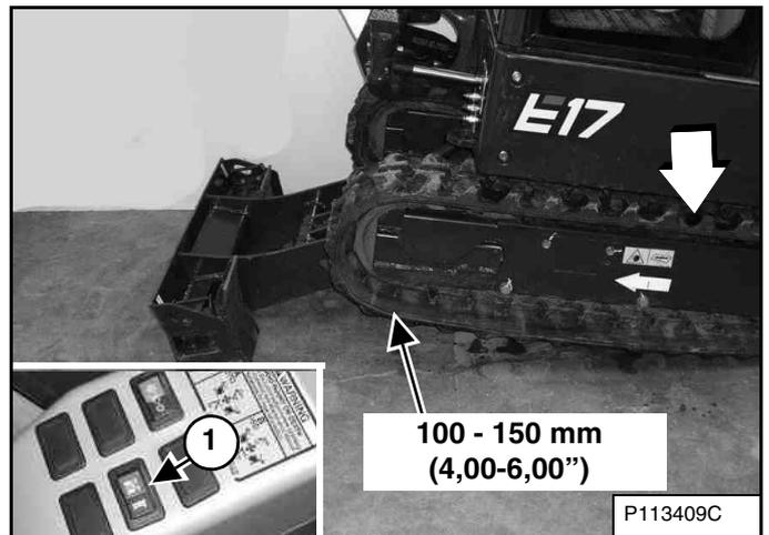
Déplacez le contacteur de commande de la lame / d'écartement et de rapprochement des chenilles (1) [Figure 52] vers la droite en position lame.
