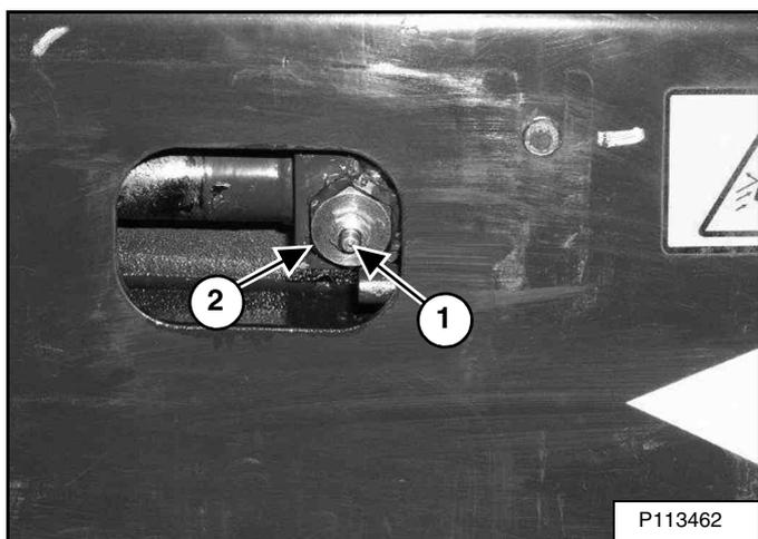
Desserrez les vis du panneau d'accès et faites pivoter le panneau pour l'ouvrir [Figure 205].
