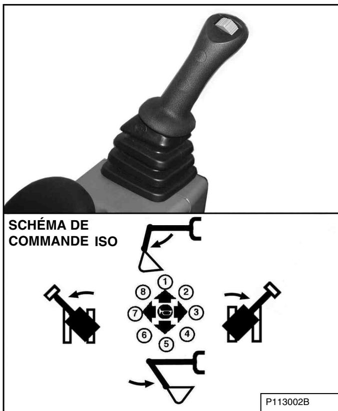
Le manipulateur gauche permet de commander le balancier et l'orientation de la tourelle [Figure 39].
