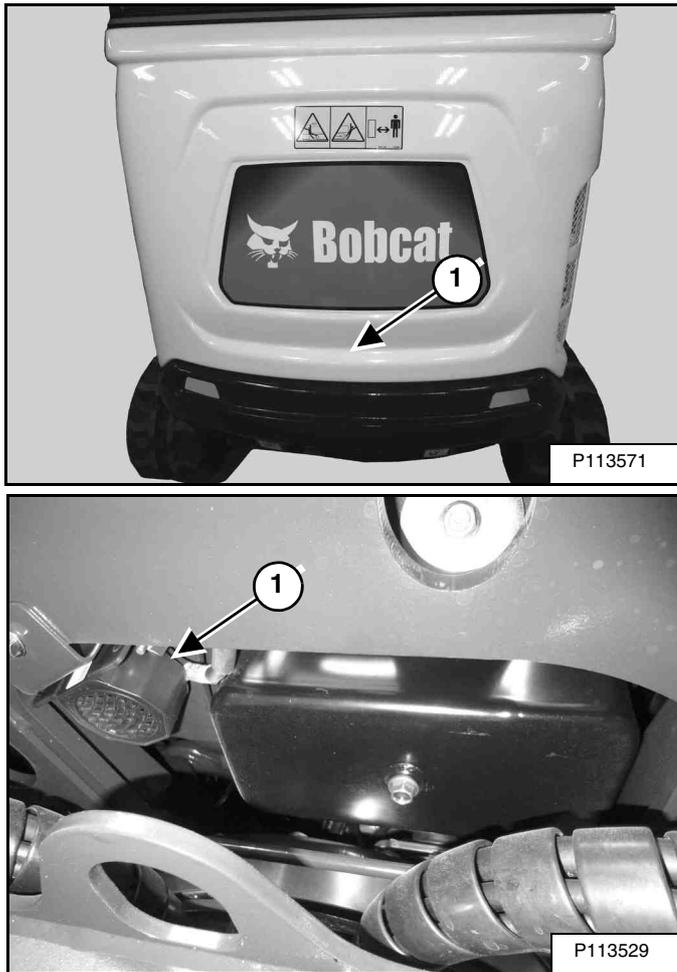
La pelle compacte peut être équipée d'un système d'alarme de déplacement. L'avertisseur de déplacement se situe dans la partie arrière (1) [Figure 31] de la pelle compacte.
