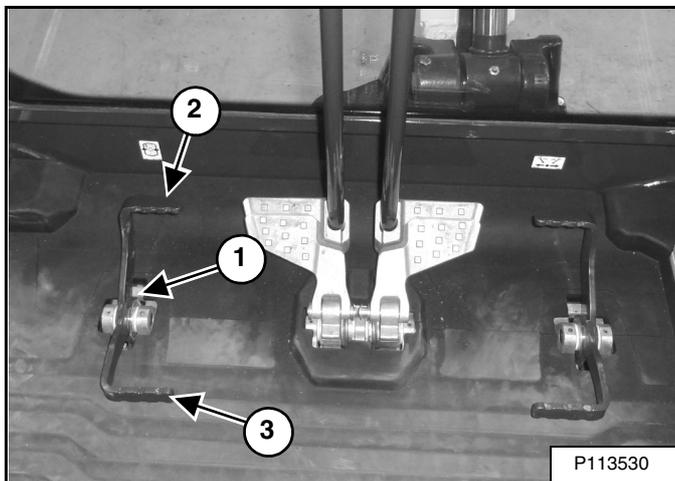
Appuyez sur l'avant de la pédale (2) [Figure 46] pour alimenter le raccord rapide femelle (selon modèle) en débit et pression hydrauliques.
