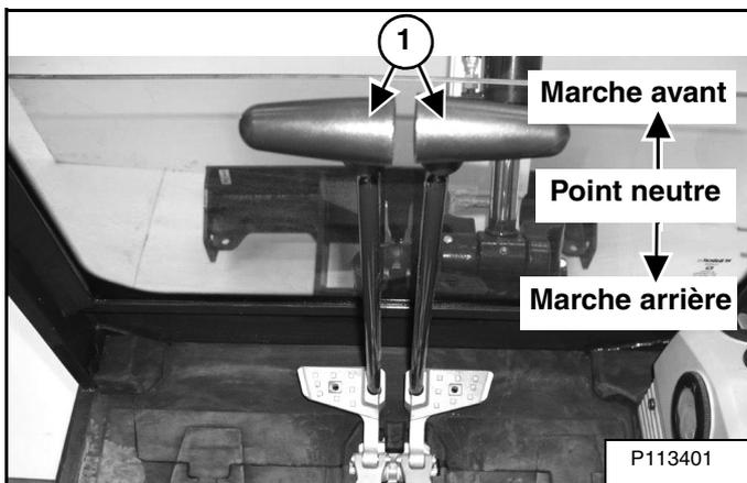
Placez les leviers de direction (1) [Figure 79] au point NEUTRE.
