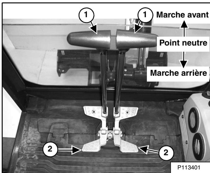
Positionnez la lame à l'avant de la machine (vue du siège de l'opérateur). Déplacez lentement les deux leviers de direction\* (1) [Figure 32] vers l'avant pour déplacer la pelle en marche avant ou vers l'arrière pour la déplacer en marche arrière.
