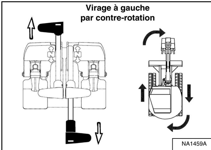
Poussez le levier de direction gauche vers l'avant et tirez le levier de direction droit vers l'arrière [Figure 35].
