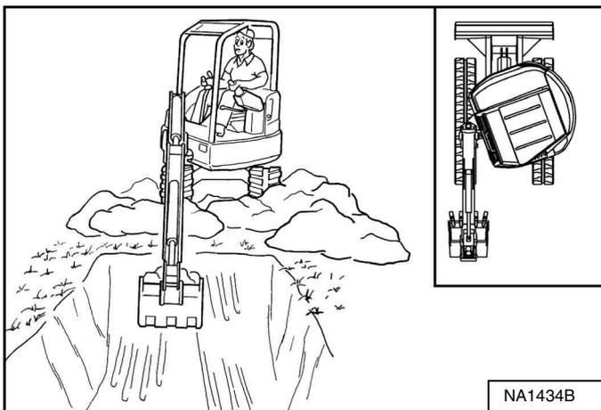
En faisant pivoter la tourelle et en déportant la flèche vers la droite [Figure 127], le centre [Figure 128] et la gauche [Figure 129], il est possible de creuser un trou carré de la largeur de la machine sans devoir la repositionner.
