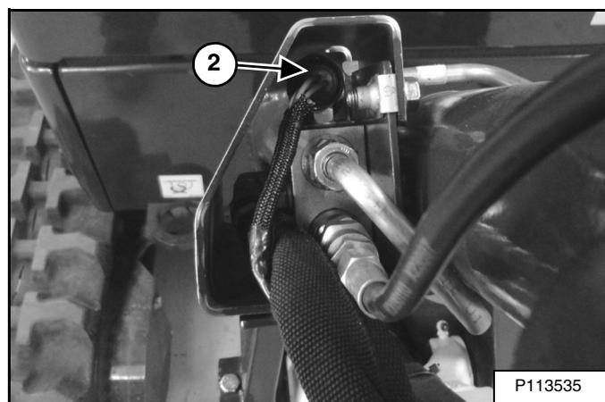
Appuyez sur la gauche du contacteur (1) pour activer le contacteur de pression (2) [Figure 68] prévu en option dans le clapet de maintien de charge de la flèche.
