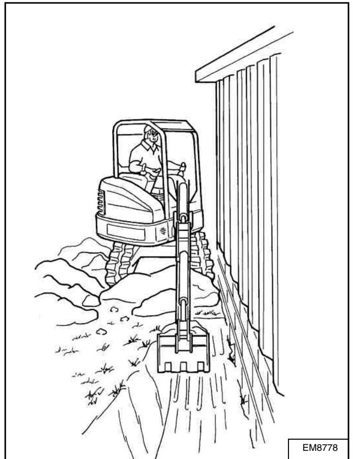
Le déport de flèche permet également de creuser au plus près d'un bâtiment ou de toute autre structure [Figure 130].
