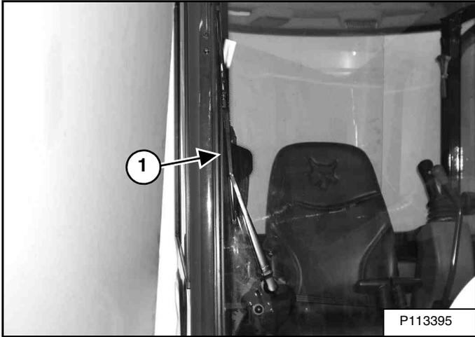
Le pare-brise avant est équipé d'un essuie-glace (1) [Figure 23] et d'un lave-glace.
