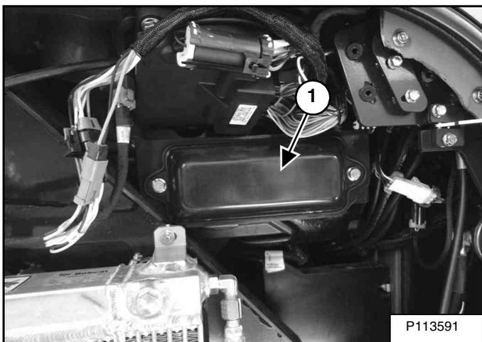
La pelle compacte est alimentée par un système électrique 12 V à masse négative. Le système électrique est protégé par des fusibles qui se trouvent sous le capot latéral droit de la pelle compacte (1) [Figure 182]. Les fusibles protègent le système électrique contre les surcharges. La cause de toute surcharge doit être identifiée et corrigée avant de remettre le moteur en marche.
