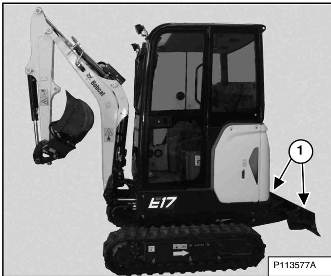
Étendez complètement les vérins du godet, du balancier et de la flèche de façon à positionner la pelle compacte comme illustré sur la [Figure 143].
