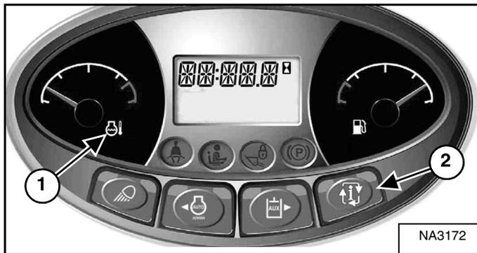
Surveillez fréquemment les jauges de température et de carburant [Figure 85].
