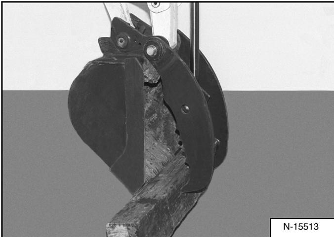
La pince hydraulique en option augmente les possibilités d'utilisation de la pelle compacte ainsi que son efficacité pour le ramassage des débris [Figure 118].
