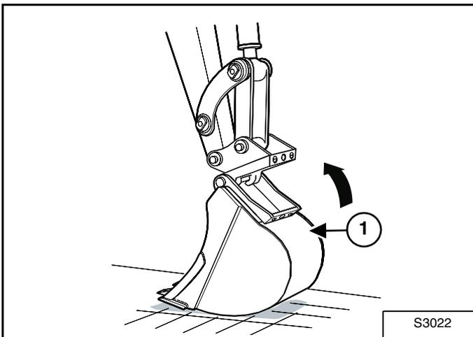
Rétractez le vérin de godet pour sortir l'attache rapide Bobcat de l'adaptateur [Figure 98].
