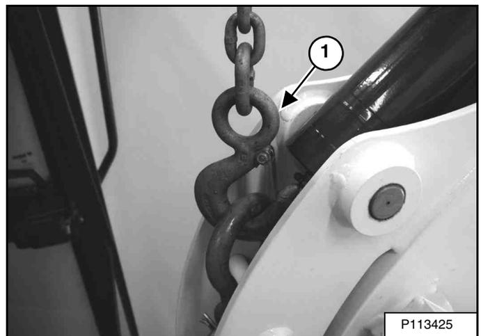
Fixez des chaînes aux extrémités de la lame (1) [Figure 143] et [Figure 144] et à un support de levage au-dessus de la cabine / du canopy. Le dispositif de levage doit s'étendre au-delà des côtés de la cabine ou du canopy pour éviter que les chaînes heurtent la protection ROPS / TOPS.
