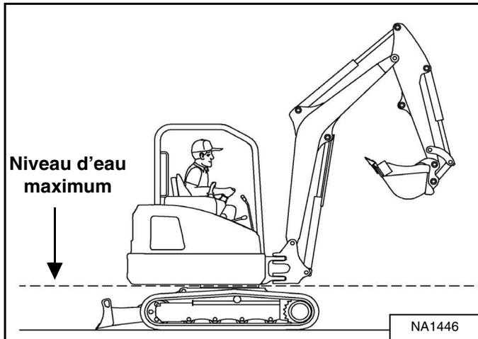
N'utilisez jamais et n'immergez jamais la pelle compacte dans l'eau au-delà du bas de la couronne d'orientation [Figure 139].
