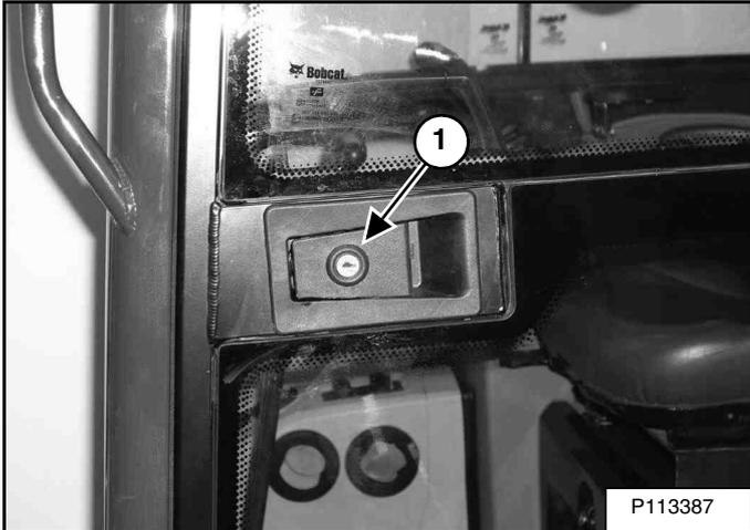
La porte de la cabine (1) se verrouille [Figure 15] à l'aide de la clé de contact. Tirez sur le loquet pour ouvrir la porte.
