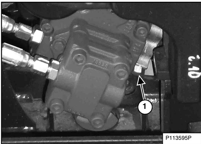
Le bouchon de vidange d'huile hydraulique (1) [Figure 197] se trouve sur le raccord d'admission de la pompe hydraulique.
