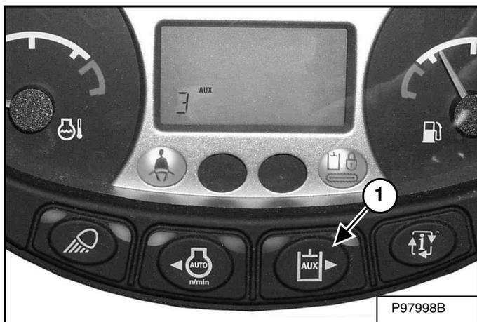
Si les auxiliaires hydrauliques sont désactivés, appuyez sur le bouton du circuit hydraulique auxiliaire (AUX) (1) [Figure 45], puis déplacez le contacteur (1) [Figure 44] vers la droite et la gauche à plusieurs reprises.
