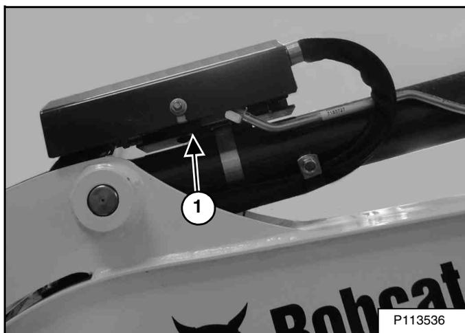
Si la pelle compacte est équipée d'un clapet de maintien de charge du balancier (1) [Figure 64], celui-ci est monté à l'extrémité base du vérin de balancier, comme illustré.
