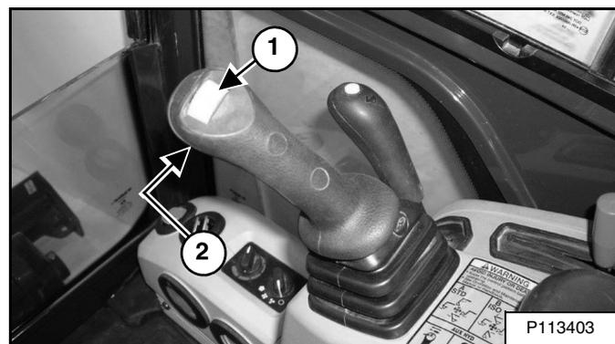
Déplacez le contacteur (1) [Figure 44] du manipulateur droit vers la droite pour alimenter le raccord rapide femelle en débit hydraulique. Déplacez le contacteur vers la gauche pour alimenter le raccord rapide mâle en débit hydraulique. Si le contacteur est placé à mi-course, les fonctions auxiliaires se déplacent à une vitesse réduite environ de moitié.
