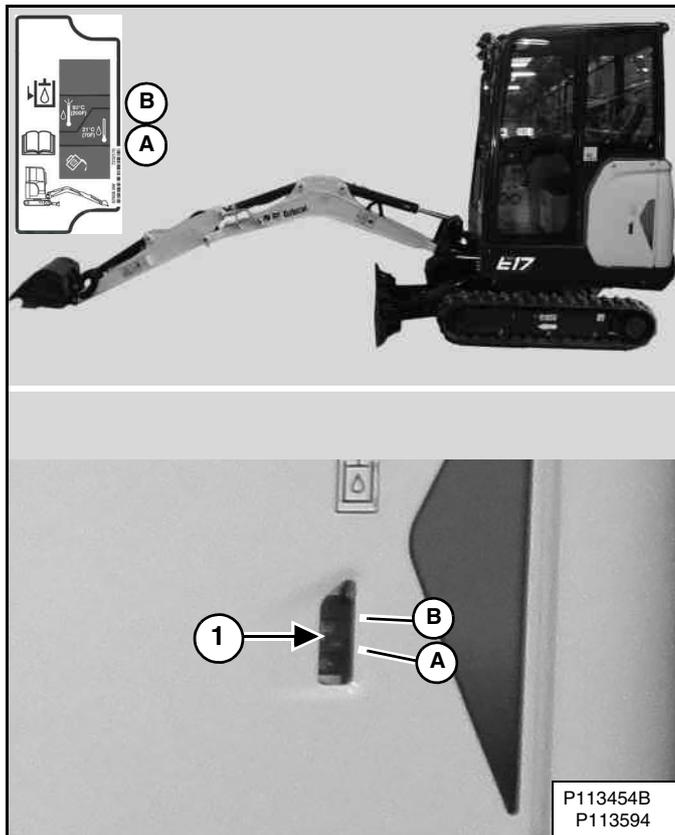
Garez la machine dans la position indiquée [Figure 193]. (Contrôlez de préférence l'huile hydraulique lorsqu'elle est froide.)
