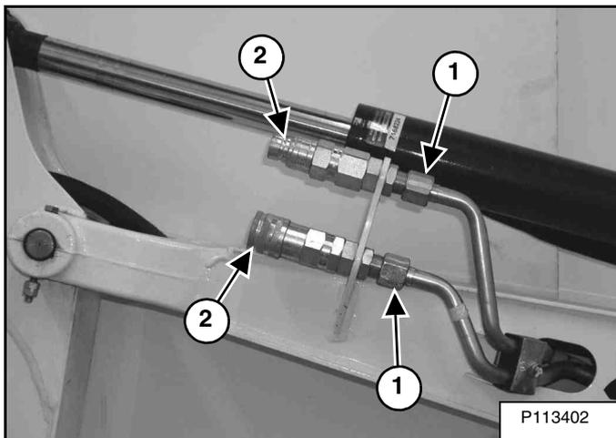
La pelle compacte est équipée de conduites hydrauliques (1) [Figure 41] pour alimenter les accessoires en huile hydraulique.
