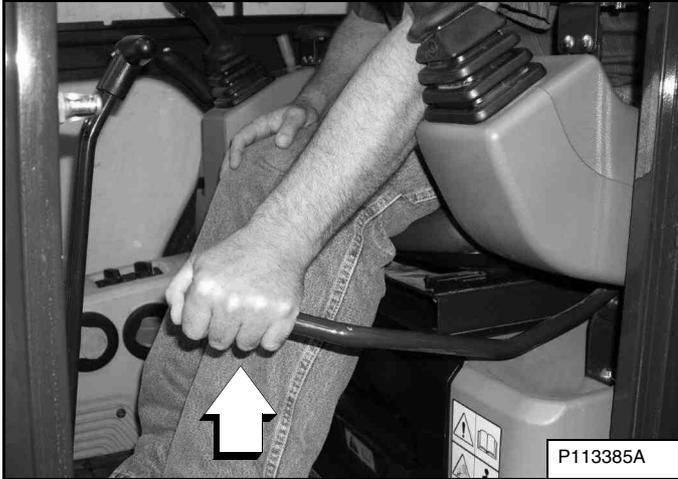
Tirez sur le levier de déverrouillage **[Figure 14]**. Le ressort de levage facilite le levage de la console.
