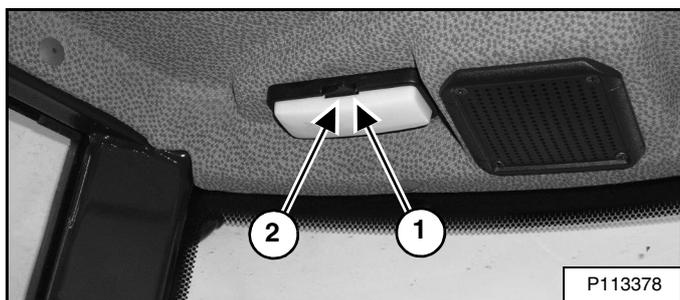
Appuyez sur la droite du contacteur (1) pour allumer l'éclairage. Appuyez sur la gauche du contacteur (2) [Figure 7] pour éteindre l'éclairage.
