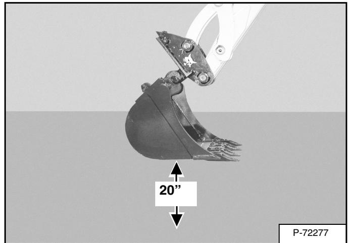
Levez la flèche jusqu'à obtenir un écart d'environ 20,0" (500 mm) entre le bas de l'accessoire et le sol [Figure 105].
