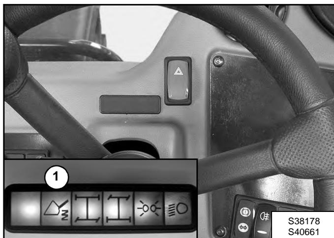
Une fois la fonction activée, le témoin de suspension de la flèche (1) [Figure 67] s'allume.
