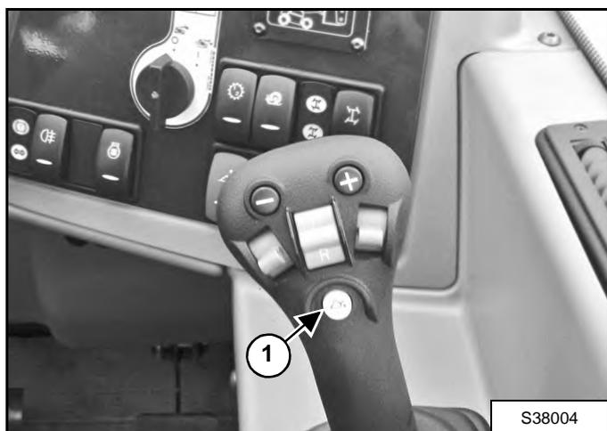
Appuyez sur le bouton inférieur (1) [Figure 66] du manipulateur tout en tirant sur le manipulateur jusqu'à ce que la flèche commence à se lever.
