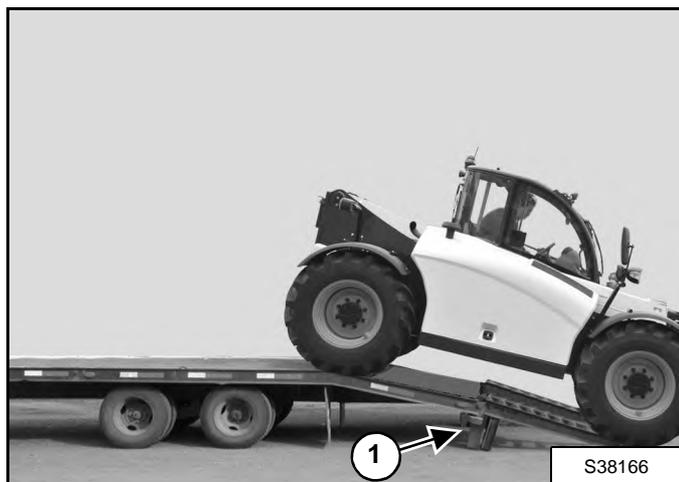
Le télescopique doit être chargé en marche arrière sur la remorque ou le véhicule de transport.
