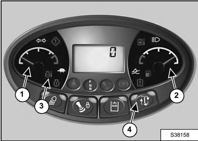
Surveillez fréquemment les jauges de température (1) et de carburant (2) [Figure 90].
