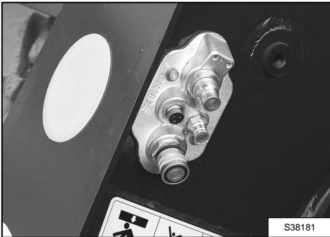
Connexion : éliminez la saleté ou les débris accumulés sur la face des raccords rapides mâles et femelles ainsi que sur le pourtour des raccords rapides mâles. Contrôlez visuellement les raccords pour vous assurer qu'ils ne présentent pas de corrosion, de fissure, d'endommagement ou d'usure excessive. Le cas échéant, remplacez le(s) raccord(s) [Figure 78].
