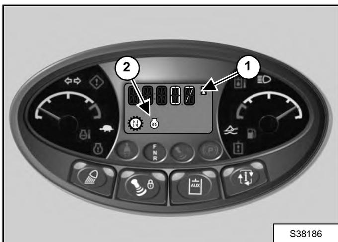
Laissez la clé en position MARCHE jusqu'à ce que le compte à rebours de préchauffage du moteur (1) [Figure 89] affiché à l'écran passe de 10 à 0 secondes.
