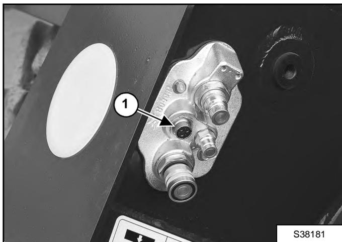
Reliez le faisceau électrique de l'accessoire au connecteur du module de commande des accessoires (1) [Figure 79].
