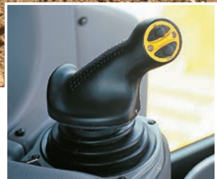
Système ergonomique PCCS (Palm Command Control System)
