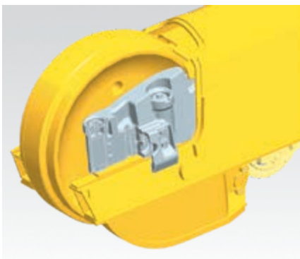
Support de roue folle à réglage automatique
