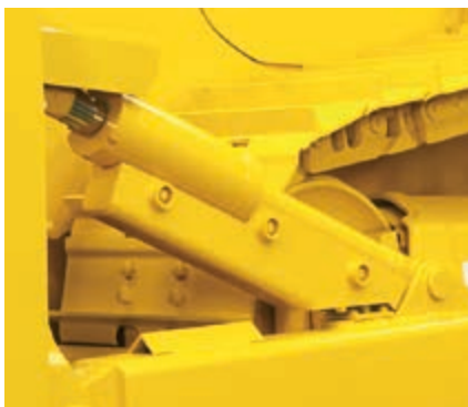
Dans la mesure du possible, les conduites hydrauliques sont intégrées dans les structures
