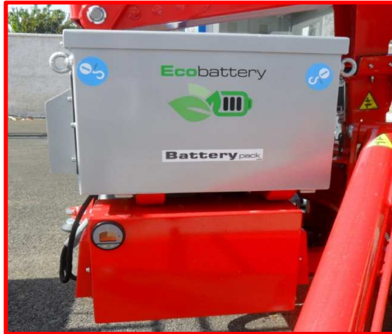
Figure 17 : bloc batteries au lithium.
