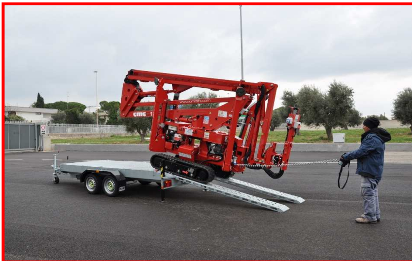
Figure 13 : chargement / déchargement à l'aide d'une rampe.
