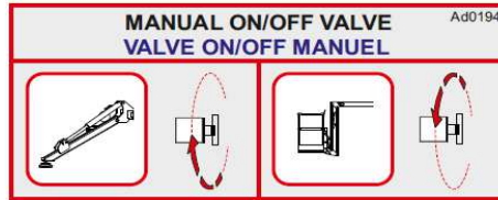
Figure 62 : électrovanne stabilisateurs/partie aérienne.
